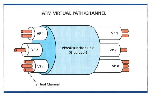
Bild 2. Beim ATM werden virtuelle Pfade und virtuelle Kanäle geschaltet.
