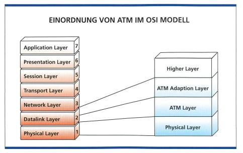
Bild 1. Das ATM-Protokoll ist im unteren Bereich der Schicht 2 nach OSI einzuordnen.
