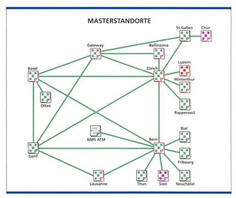
Bild 9. An den kleineren Standorten sind Accessknoten installiert.
