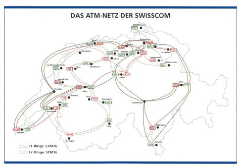
Bild 4. Das schweizerische ATM-Netz basiert auf dem SDH-Netz von Swisscom.
