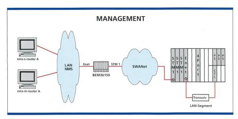
Bild 15. Bei den SIMUX 36150 kann die Anbindung der Netzelemente nicht redundant durchgeführt werden.
