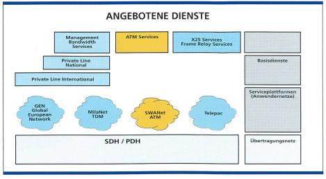
Bild 16. Eingliederung von SWANet im Netzschichtenmodell.
