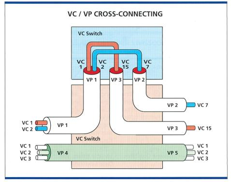
Bild 3. Bei einer ATM-Zelle werden virtuelle Kanäle in einem virtuellen Pfad zusammengefasst.
