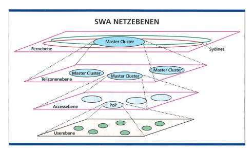
Bild 6. Im SWANet werden mehrere Netzebenen gebildet.
