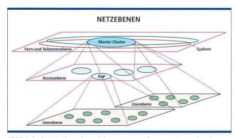
Bild 7. Beim SWANet kann der Verkehr vom roten aufs grüne Netz nur über den Mastercluster erfolgen.
