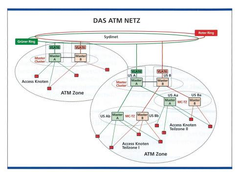
Bild 5. In den Teilzonen erfolgt eine sternförmige Verteilung der Daten.
