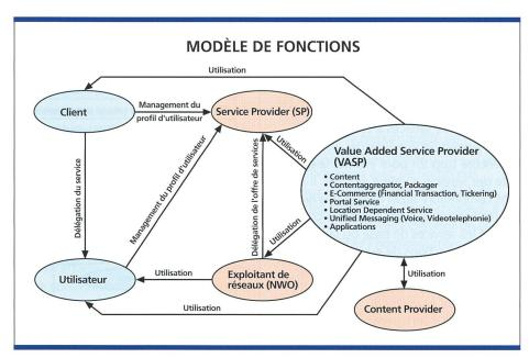
Fig. 2. Modèle de fonctionnement de l'UMTS (profil des utilisateurs, gestion de ces données: chaque utilisateur a un profil qui détermine à quels services il a accès; le profil d'un utilisateur indique par exemple quel abonnement cet utilisateur détient ou encore des données intéressant l'opérateur ou le fournisseur d'accès, comme l'adresse, etc.).
