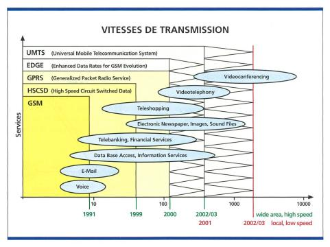
Fig. 3. Vitesses de transmission des réseaux mobiles.
