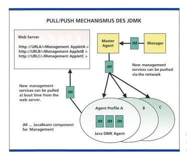
Bild 5. Pull- und Push-Mechanismen des ID.
