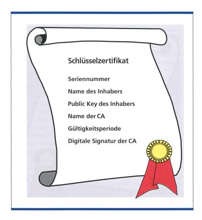
Bild 2. Inhalt des Schlüsselzertifikats.
