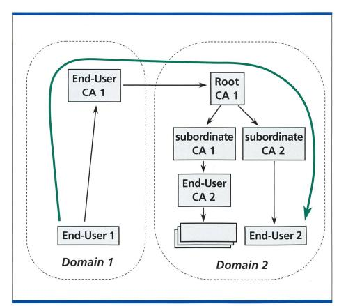
Bild 5. Zertifikatskette. Die Pfeilrichtung bezeichnet, wer wen überprüft.
