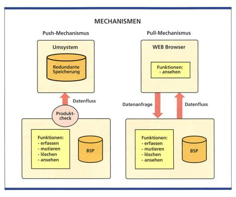
Bild 2. Datenübertragung mittels Push- und Pull-Mechanismus.
