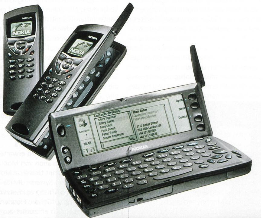
Bild 5. Der 9110-Communicator ist ein multifunktionell einsetzbares Gerät, das unter anderem auf dem Display Bewegtbilder von einer Digitalkamera anzeigt, die es über Infrarotschnittstellen via IR-TranP-Protocol aufnehmen kann.
