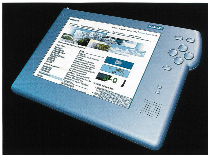
Bild 1. Der SIMpad von Siemens ist ein drahtloser Internetterminal mit Farbdisplay, mit dem man ohne langes Aufstarten und mit einfacher Bedienung ins Internet gelangt.
