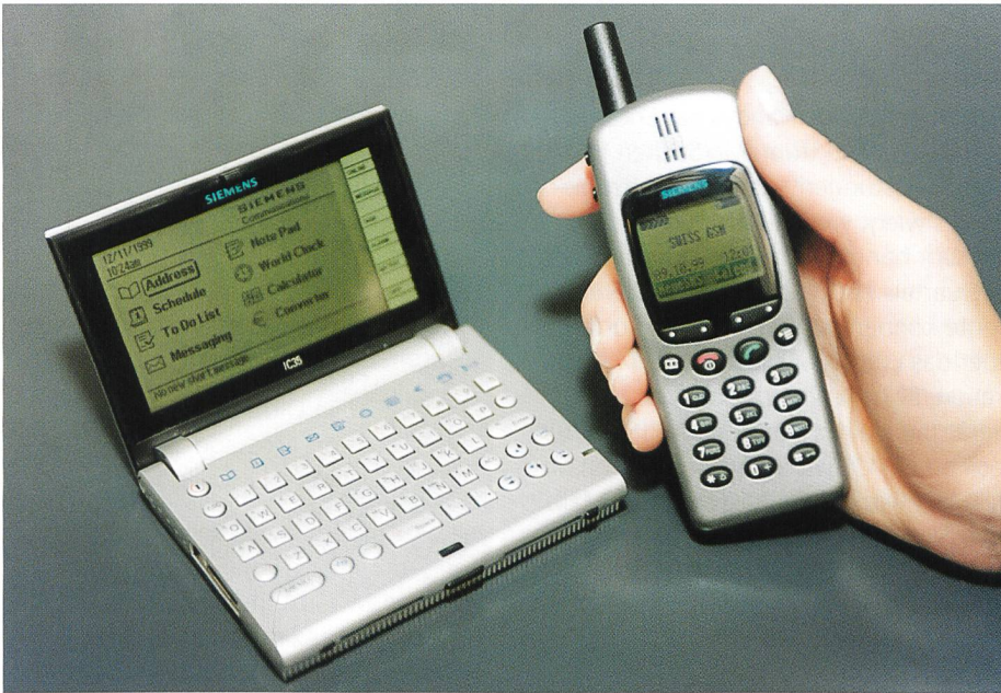
Bild 2. «IC35 – The Unifier», ein kleiner, mobiler Begleiter im Format eines Zigarettenetuis. Er ermöglicht in Verbindung mit einem Handy und eingebauter Infrarotschnittstelle das Verschicken von E-Mails, SMS-Nachrichten und Faxnachrichten.
