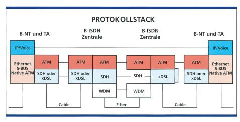
Bild 3. Protokollstack für das Breitband-ISDN.
