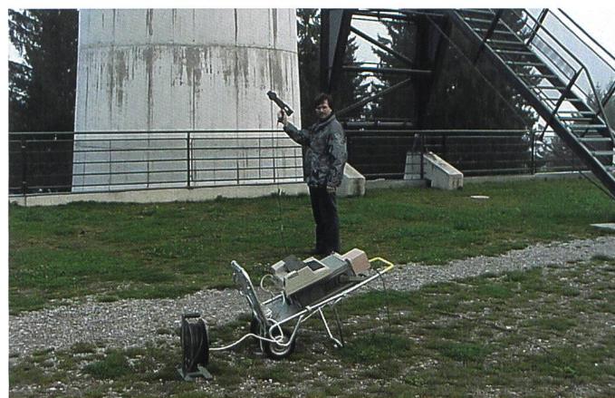
Bild 5. Spektrumanalysator zusammen mit tragbarer, handlicher Richtantenne.
