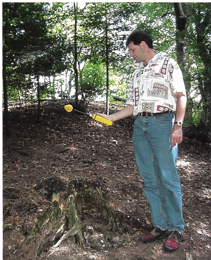
Bild 4. Tragbares Messgerät mit isotrop wirkender Antenne.
