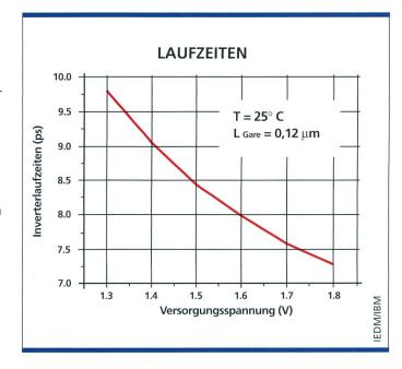
Bild 4. Laufzeiten im Ringoszillator abhängig von der Gatelänge (a) und Laufzeiten abhängig von der Versorgungsspannung (b) für die von IBM vorgeschlagene CMOS-Technologie im Anwendungsbereich >1 GHz.
