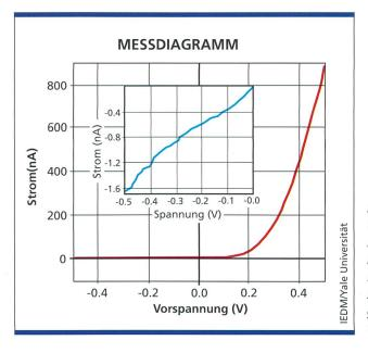
Bild 9. Diodenähnliche U/I-Charakteristik, gemessen an einem organischen Molekül bei Raumtemperatur. Im Insert ist der Bereich negativer Vorspannung vergrössert dargestellt.
