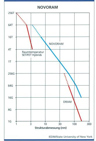
Bild 8. Das NOVORAM, ein nichtflüchtiger Halbleiterspeicher auf der Basis des Fowler-Nordheim-Tunneleffekts, könnte eines Tages die heutigen DRAM ablösen. Bei gleichen Strukturabmessungen lassen sich wahrscheinlich NOVO-RAMs mit grösseren Gesamtkapazitäten bauen, vorausgesetzt, man findet eine Technologie für die Grossserienfertigung.
