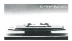
Bild 11. Einen Querschnitt durch den verwendeten HBT im Frequenzteiler für 69 GHz zeigt das Bild, das mit dem Scanning Electron Microscope (SEM) gemacht wurde. Indiumphosphid ist ein eher exotisches und nicht gerade einfach zu bearbeitendes Material – es ist aber gut für Bauelemente, ist bei extrem hohen Frequenzen einsetzbar.
