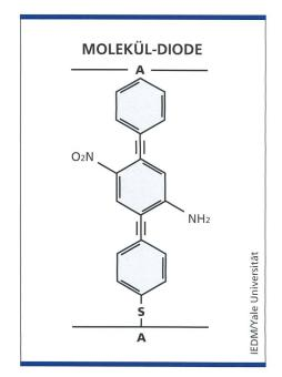
Bild 10. Schematischer Aufbau einer Molekülstruktur mit negativem differenziellem Widerstand.
