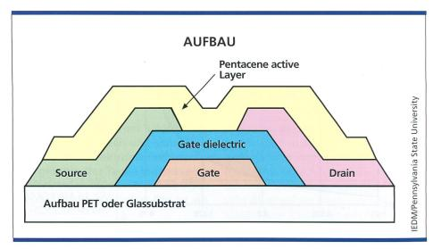
Bild 5. Prinzipieller Aufbau eines organischen Pentacene-Dünnfilmtransistors.
