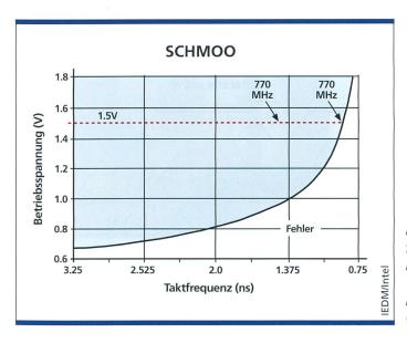
Bild 3. F<sub>max</sub>-Schmoo für 16 Mbit SRAM mit dem CMOS-Transistor, der nur noch 100 nm Gatelänge hat.
