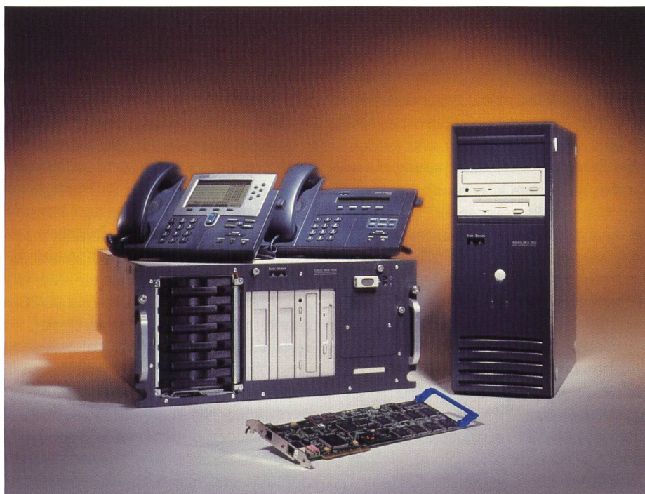
Bild 4. Cisco-MCS-7835 mit den beiden IP-Telefonen 7910 und 7960 in einer typischen Cisco-Umgebung.
