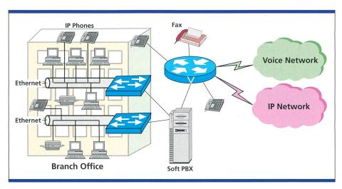
Bild 2. Grobstruktur einer Soft-PBX (Standard-HW, Erschliessen der IP-Telefone via geswitchtes LAN); Anschluss über Gateway inklusive Gatekeeperfunktionen an das öffentliche ISDN oder an ein öffentliches oder privates IP-Netz.
