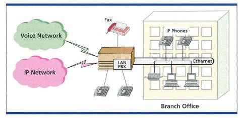
Bild 3. Grobstruktur einer LAN-PBX (Standard-HW, Erschliessen der IP-Telefone via geswitchtes LAN); Anschluss über Gateway inklusive Gatekeeperfunktionen an das öffentliche ISDN, später auch an ein öffentliches oder privates IP-Netz.
