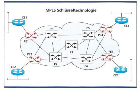
Bild 2. Multi Protocol Label Switching ermöglicht die Priorisierung des Datenverkehrs und damit Echtzeitanwendungen (Sprache und bewegte Bilder) über das WAN.
