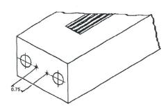
Bild 5. Mini-MT-Ferrule mit zwei Fasern.
