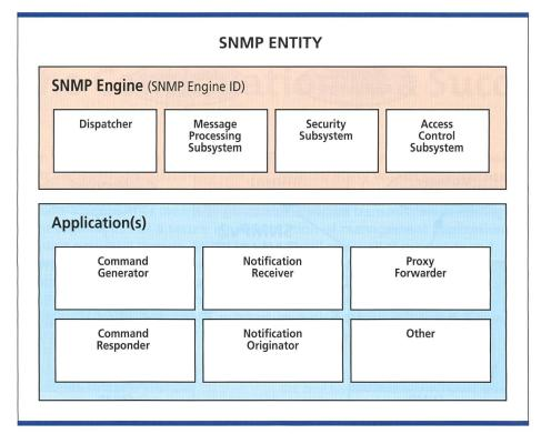
Fig. 3. An SNMP Entity and ist compenents.
