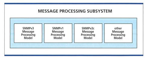
Fig. 4. Message Processing Subsystem.
