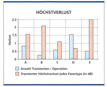
Bild 4. Vergleich zwischen dem Auftreten von Transienten und dem durchschnittlichen Verlust für jeden Fasertyp.
