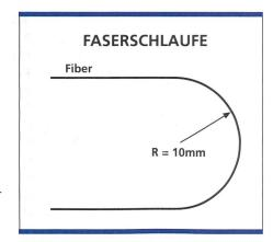
Bild 1. Biegesensibilitätstest für Fasern.
