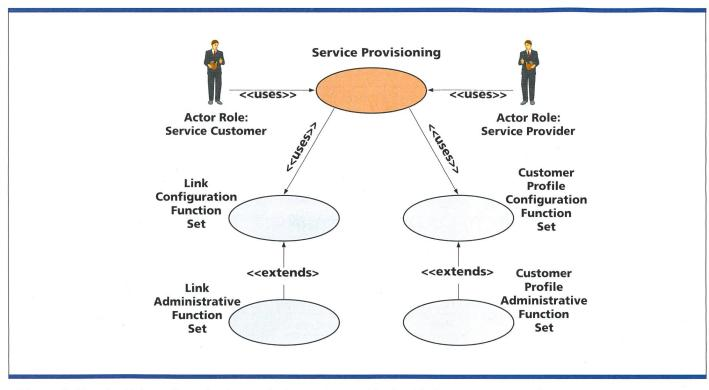
Bild 5. Definition der Link Configuration innerhalb des Service Provisioning [draf rec. ITU-T M.3020].
