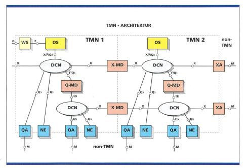
Bild 2. Physikalische TMN-Architektur [draffrec. ITU-T M.3010/M.3013 (1999)].
