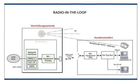
Bild 5. Radio-In-The-Loop (RITL): Fixed Radio Access-BroadBand (FRA-BB).
