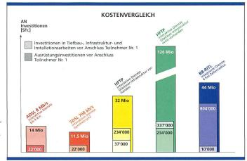
Bild 6. Die Kosten verschiedener technischer Lösungen für die Erbringung interaktiver NB- und BB-Dienste.
