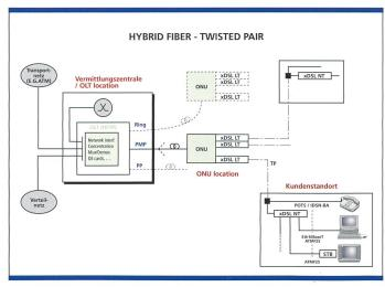
Bild 4. Hyprid Fiber-Twisted Pair (HFTP).
