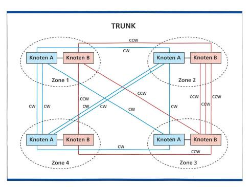
Bild 5. Die Fernebene verbindet Knoten unterschiedlicher Accessebenen (Zonen). Mittels SydiNet (SDH) sind diese zu Ringen zusammengeschaltet.
