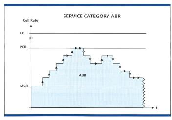
Bild 8. Dienstkategorie ABR. Der Sender passt die Übertragungsrate dynamisch den freien Netzressourcen an.
