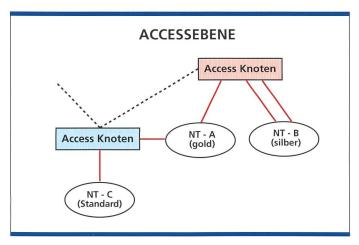
Bild 4. Die verschiedenen Varianten, wie ein NT physikalisch an der Accessebene angeschlossen werden kann.
