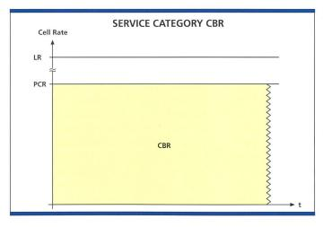
Bild 6. Dienstkategorie CBR. LR = Link Rate (Bandbreite des Anschlusses des Kundenstandortes).
