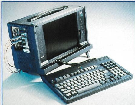
Der WireSpeed 622 Mbit/s ATM Protokoll-Analyzer ist ein portables Fehler- und Leistungsmanagement-Tool für High-Speed-ATM-Backbones. Dank der auf Java basierenden Benutzeroberfläche für Windows NT und einer speziell entwickelten Netzwerkkarte unterstützt der WireSpeed Geschwindigkeiten bis zu 622 Mbit/s. Der WireSpeed erfüllt die Testanforderungen von heutigen Backbone- und High-Speed-Server-Links. Riesige Datenmengen, Sprach- und Video-
