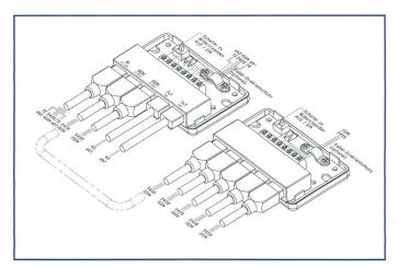
Bild 4. Innenleben der NT 2ab- und Mini-S-Bus-Verteiler.
