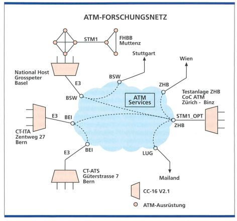
Bild 4. Das nationale ATM-Forschungsnetz mit Übergängen ins Ausland.
