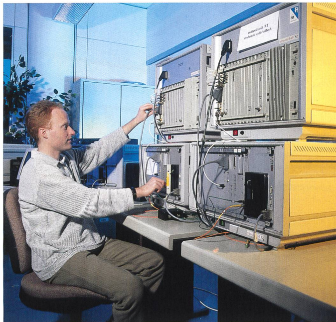
Bild 6. ATM-Terminal-Adapter für TV-Distribution. Die ATM-terminal-Adapter (Empfänger) wandeln die ATM-Zellen in analoge Signale (Fernsehsignale) um. Sie sind netzseitig an die ATM-Plattform und anschlussseitig am Fernseher angeschlossen.
