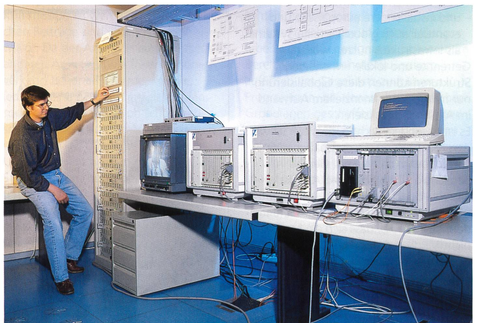
Bild 5. Blick in die Forschungsräume des Swiss National Host. Einspeisung der TV-Programme in die ATM-Plattform. TV-Programme werden via Satelliten-Kommunikations-Empfangseinrichtungen via Video-Coder dem ATM-Terminal-Adapter (Sender) zugespiessen (Bilder 5 bis 7: H.R. Bramaz)
