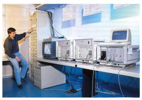
Bild 5. Blick in die Forschungsräume des Swiss National Host. Einspeisung der TV-Programme in die ATM-Plattform. TV-Programme werden via Satelliten-Kommunikations-Empfangseinrichtungen via Video-Coder dem ATM-Terminal-Atapter (Sender) zugespiesen (Bilder 5 bis 7: H.R. Bramaz)
