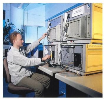
Bild 6. ATM-Terminal-Atapter für TV-Distribution. Die ATM-terminal-Atapter (Empfänger) wandeln die ATM-Zellen in analoge Signale (Fernsehsignale) um. Sie sind netzseitig an die ATM-Plattform und anschlussseitig am Fernseher angeschlossen.
