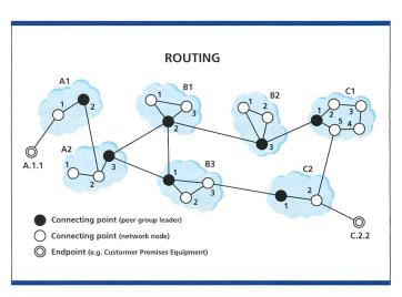
Bild 2. Routing in einem P-NNI-Netz.
