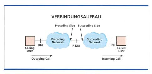
Bild 4. Verbindungsaufbau in einem P-NNI-Netz (Beispiel).
