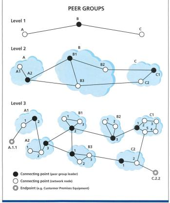
Bild 3. Hierarchische «Peer Groups» innerhalb eines P-NNI-Netzes.
