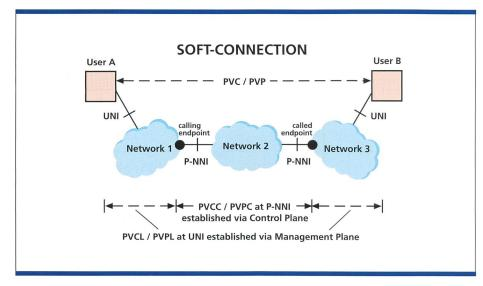
Bild 6. «Soft Connections» innerhalb eines P-NNI-Netzes.
