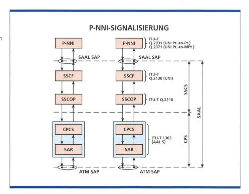
Bild 5. P-NNI Signalisierung oberhalb der SAAL.
