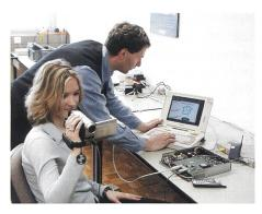
Ruedi Brügger steuert über Wireless-LAN die DV-Kamera von Sibylle Aregger, welche über Firewire mit dem Residential Gateway (vorne rechts) verbunden ist.
