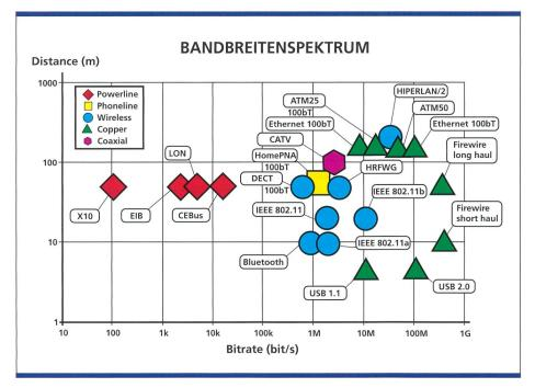
Bild 3. Das Angebot und das Bandbreitenspektrum einiger Home-Network-Technologien.
