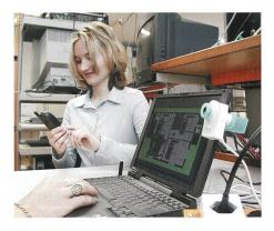
Sibylle Aregger hat eine SMS-Meldung empfangen, die von der Kamera vorne rechts ausgelöst wurde. Jetzt sendet sie eine SMS-Meldung, welche die Stereoanlage einschalten wird.
