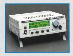
traschallbereich. Schaltbare Zeitkonstanten sowie ein über den Bus schaltbarer Bargraph erlauben die Beurteilung kritischer Signale mit stark schwankendem Pegel, wie sie für viele Applikationen typisch sind. Serienmässige Filter- und Sonderfunktionen, wie Psophometer-, Klirrfaktor- oder Selektivmessung, erweitern den Anwendungsbereich.
