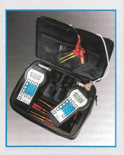
Übereinstimmung notwendig geworden sind. Mit der SLK-Familie gewinnen die Vermittler oder Installateure eine besonders attraktive Messlösung. Mit den handlichen SLK-Geräten werden automatisch alle notwendigen Messungen ausgeführt, um eine schnelle und zuverlässige Streckenqualifikation vorzunehmen. Zusätzlich sind die SLK-Geräte eine wertvolle Hilfe in der Störungs- und Fehlersuche.
