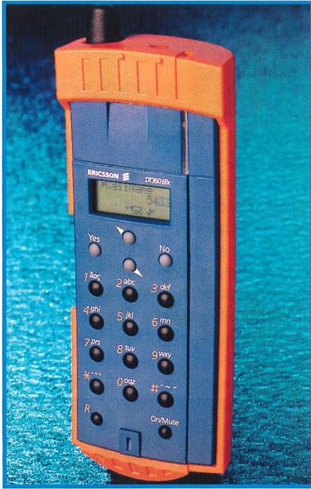
DECT-Cordlesstelefon von Ericsson für die Kommunikation in explosionsgefährtetem Umfeld.
