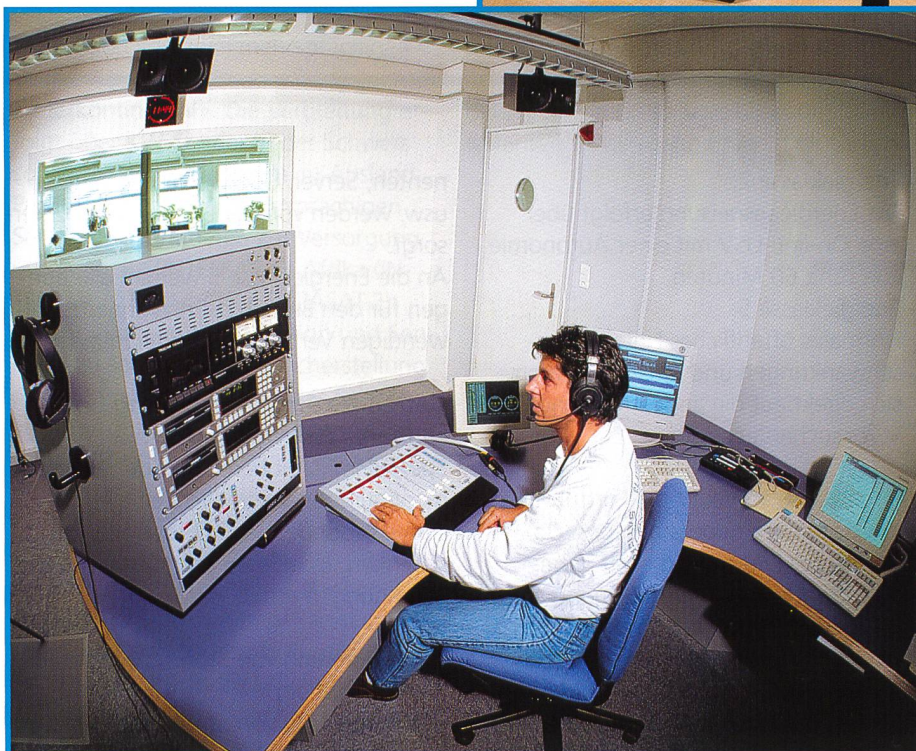
▼ Bild 5. Studioarbeitsplatz A1 mit Peripheriegeräten, Mischpult, im Hintergrund die Bildschirme für das digitale Tonbearbeitungssystem links und das Redaktionssystem rechts.
