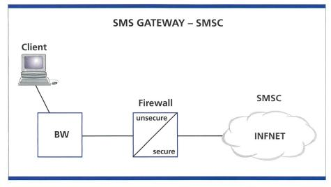
Bild 2. Schema der Verbindung vom SMS Gateway via Firewall zum SMSC.
