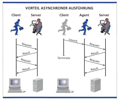
Bild 6. Vorteil asynchroner Ausführung von MAs.
