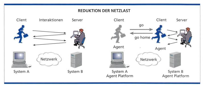
Bild 7. Reduktion der Netzlast und Rechenleistung am Client.
