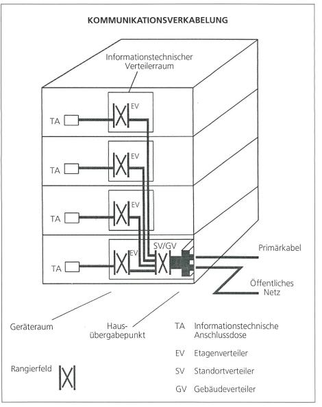
Bild 1. Möglicher Aufbau einer Kommunikationsverkabelung nach EN 50173.
