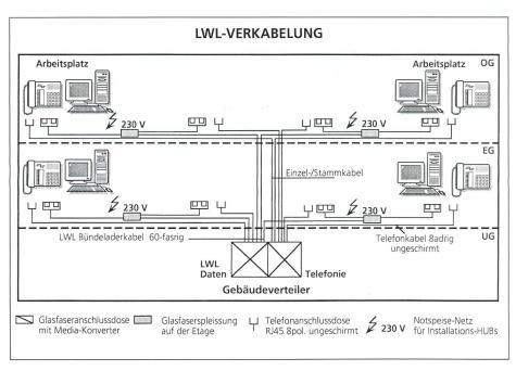
Bild 3. Installations-Hub-Lösung.
