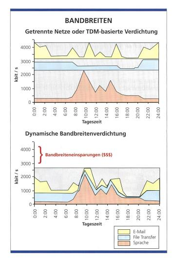
Bild 3. Effizientere Ausnutzung der Übertragungsbandbreite dank dynamischer Bandbreitenzuteilung.
