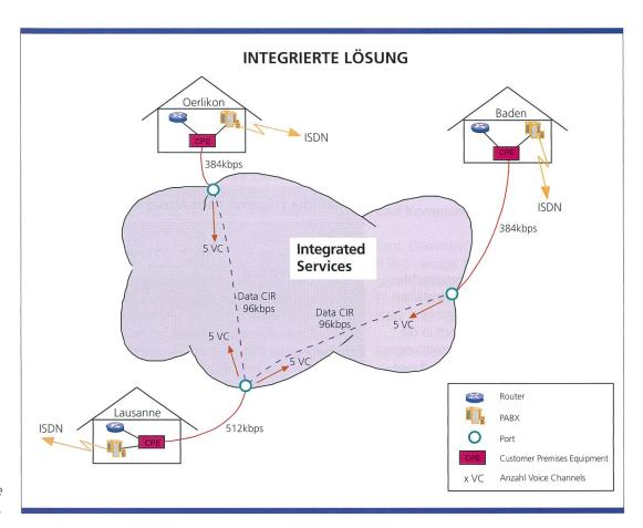
Bild 5. Die integrierte Lösung.
