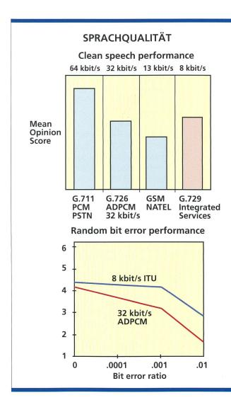
Bild 2. Vergleich der Sprachqualität bei unterschiedlichen Komprimierungsverfahren. Der für Integrated Services eingesetzte, von der ITU empfohlene Algorithmus nach G.729 zeigt eindeutig bessere Resultate als das herkömmliche ADPCM-Verfahren.
