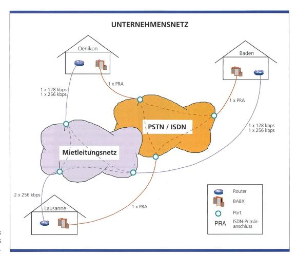
Bild 4. Ist-Zustand des Unternehmensnetzes der Firma Integra.
