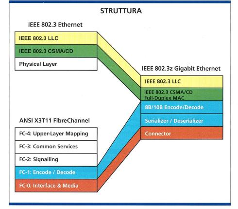
Fig. 1. Struttura ibrida di Gigabit Ethernet.
