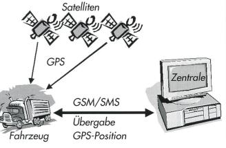
Die Funktion der Telematik Box reicht von der Darstellung der einzelnen Fahrzeugpositionen auf einer elektronischen Strassenkarte in der Zentrale; bis hin zu Anzeige von Ereignissen an und im Fahrzeug wie zum Beispiel: Zündung ein/aus, Ladebrücke angehängt, Notruf, Alarmanlage oder Airbag ausgelöst.
