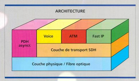
Figure 4. Architecture conventionnelle du réseau de transmission.
