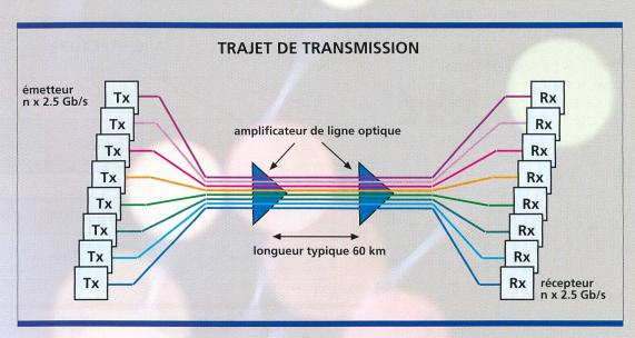
Figure 3. Trajet de transmission WDM avec amplificateurs optiques à l'erbium.
