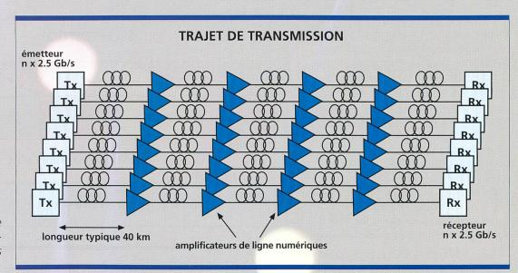
Figure 2. Trajet de transmission avec amplificateurs électroniques numériques.
