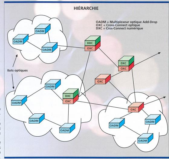
Figure 9. Réseau optique hiérarchiquement structuré en îlots optiques. Les points de jonction sont réalisés avec des éléments Cross-Connects optiques et électriques, qui peuvent également convertir les longueurs d'onde des signaux en transit.
