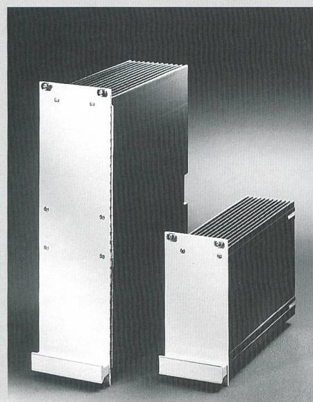
eine Schirmdämpfung von rund 60 dB bei 1 GHz möglich. Oben und unten im Tubus integrierte Kühlrippen vergrössern die Oberfläche und tragen so zu einer guten Entwärmung durch natürliche Konvektion bei. Zur besseren Wärmeableitung ist die Oberfläche der Kassette schwarz eloxiert.
