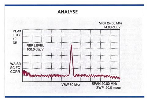
Figure 12. Voie upstream simulée avec un générateur.
