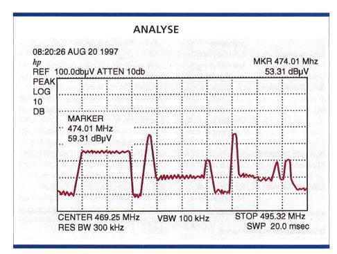
Figure 11. Voie downstream avec une porteuse TV son mono et une autre avec son stéréo.
