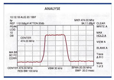
Figure 10. Analyse du canal downstream.
