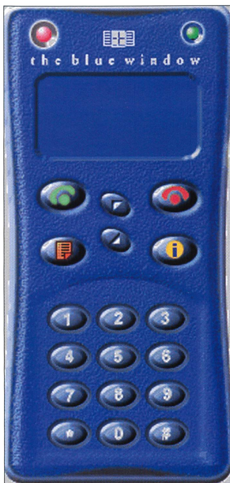
Bild 4. Die Bedienung von PC-to-Phone wurde derjenigen eines Mobiltelefons angeglichen und kommt mit einem Minimum an Tasten aus.
