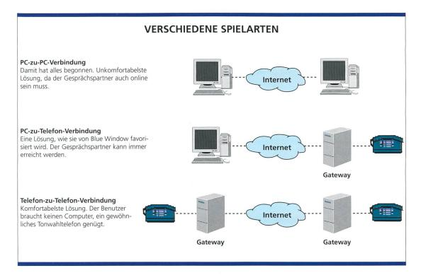
Bild 1. Möglichkeiten der Internet-Telefonie. Computer zu Computer: Die Kommunikation von einem Computer zum anderen über das Internet bildet die einfachste Variante und ist im Internet schon seit langer Zeit gang und gäbe. Vom einfachen Internet Relay Chat bis hin zur Videokonferenz mit CU-SeeMe reicht hier die Palette. und ständig kommen neue Dienste hinzu. Computer zu Telefon: Der nächste Schritt in der Internet-Telefonie: das Anwählen von ganz gewöhnlichen Telefonen oder
