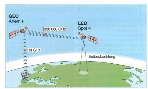
Bild 1. Schematische Darstellung der SILEX-Inter-Orbit-Versuchsstrecke zwischen dem in erdnaher Bahn umlaufenden Spot-4- und dem geostationären Artemis-Satelliten. Optische Übertragung: Entfernung 45 000 km; Sendeleistung 60 mW; Wellenlänge 0,85 µm; Datenrate 50 Mbit/s (Foto: Bosch).
