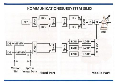
Bild 2. Bestandteile des SILEX-Kommunikations-Subsystems im LEO-Satelliten (Foto: Bosch).
