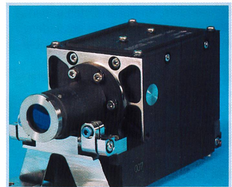
Bild 3. Flugmodell des optischen SILEX-Empfängers RFE (Receiver Front End) (Foto: Bosch).
