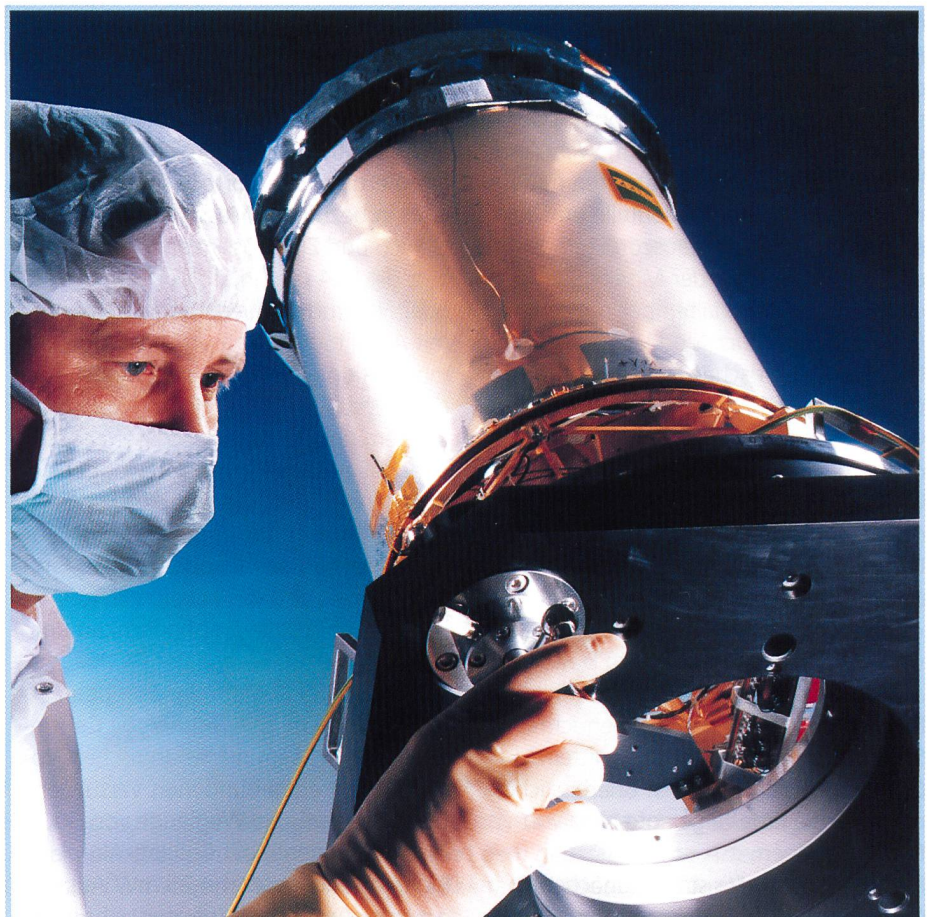
Bild 5. Montagearbeiten am SILEX-Teleskop (Foto: Zeiss).
