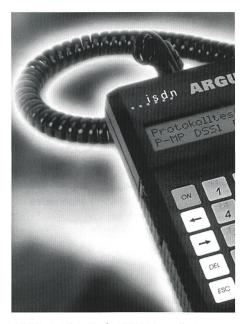
Bild 9. Prüfgerät für ISDN-Installationen und -Dienste.
