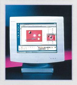
107 (30–95 kHz) sorgt für ein absolut flimmerfreies Bild mit einer Bildwiederholungsfrequenz bis zu 85 Hz bei einer Auflösung von 1280×1024 bzw. bis zu 75 Hz bei 1600×1200.
