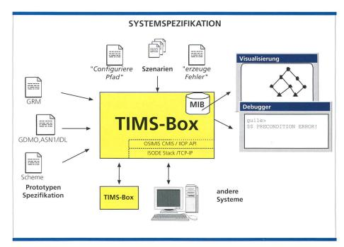
Bild 1. Nach erfolgter Spezifikation der TMN-Komponente lässt sich das Verhalten des Systems anhand von Szenarien durchspielen. Debugger und Visualierungswerkzeuge ermöglichen Einblick in die Abläufe im Systeminnern. Via Schnittstellen kann TIMS mit anderen Systemen kommunizieren.
