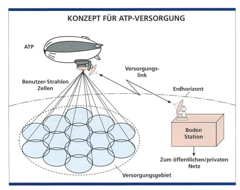
Bild 1. Generelles Konzept für eine ATP-basierte Versorgung.
