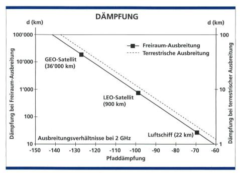
Bild 2. Dämpfung für Freiraum- und terrestrische Ausbreitung.
