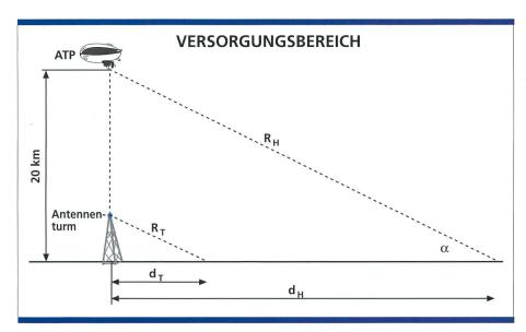
Bild 3. Versorgungsbereich, terrestrisch (PCN/Mobilfunk) und mittels ATP.
