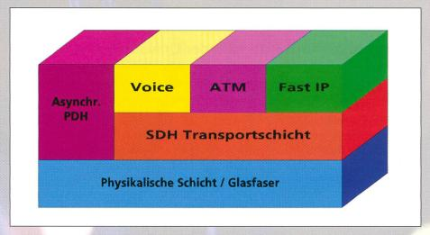
Bild 4. Herkömmliche Architektur des Übertragungsnetzes.
