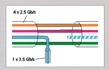
Bild 6. Drop-Funktion eines Demultiplexers.
