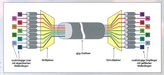
Bild 1. Prinzip der Wellenlängenmultiplexierungs-Technik.
