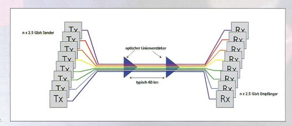
Bild 3. WDM-Übertragungsstrecke mit optischen Erbiumverstärkern.
