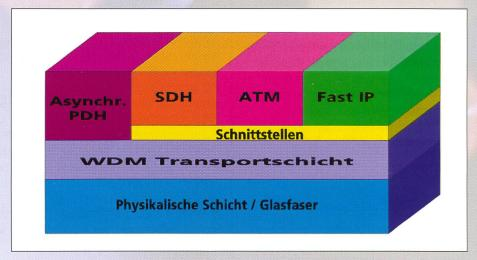
Bild 5. Mögliche WDM-basierte Architektur des Übertragungsnetzes.
