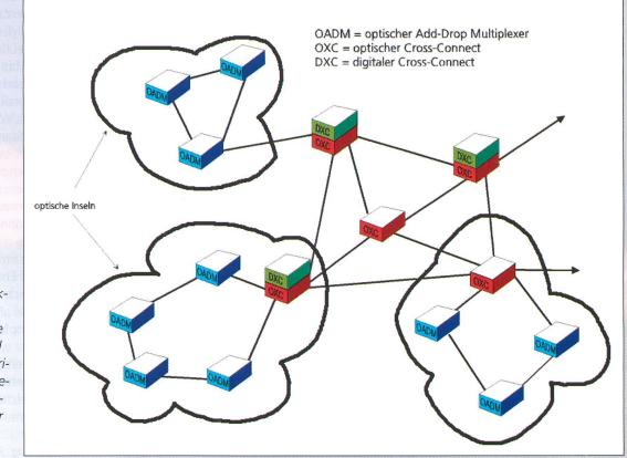
Bild 9. Hierarchisch strukturiertes optisches Netz mit optischen Inseln. Die Verbindungspunkte sind mit optischen und elektrischen Cross-Connects besetzt, die auch eine Wellenlängenkonversion der durchlaufenden Signale vornehmen können.
