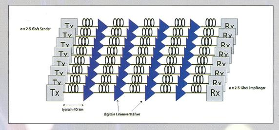
Bild 2. Übertragungsstrecke mit digitalen elektronischen Repeatern.
