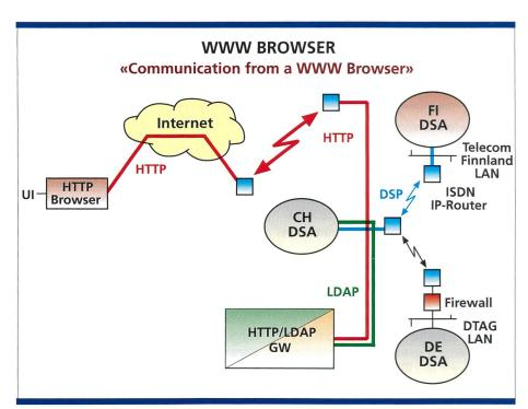
Bild 9. Kommunikation mittels eines WWW-Browsers.
