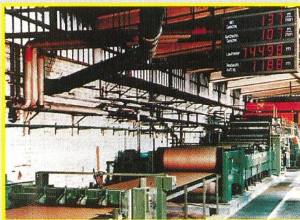
vante Daten auf grossen, gut lesbaren Anzeigegeräten darzustellen. Diese Informationen liefern zudem die Motivation zur Produktivitätssteigerung. WIBOND bietet Anzeigemodule mit Ziffernhöhen von 30 bis 200 mm an. Die einzelnen Ziffern setzen sich aus kontrastreichen, flimmerfreien Leuchtdioden zusammen, so dass eine Zusatzbeleuchtung auch unter schwierigen Bedingungen entfallen kann. Diese Anzeigemodule sind zudem staubdicht in ein Gehäuse der Schutzklasse IP 54 eingebaut.
