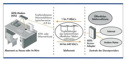
Bild 1. Funktionsweise von ADSL.
