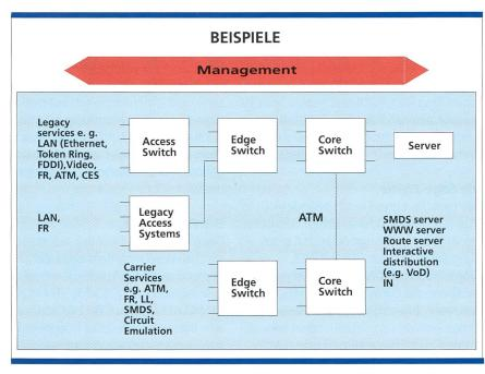
Bild 7. Lösungsbeispiel eines ATM-Netzes.
