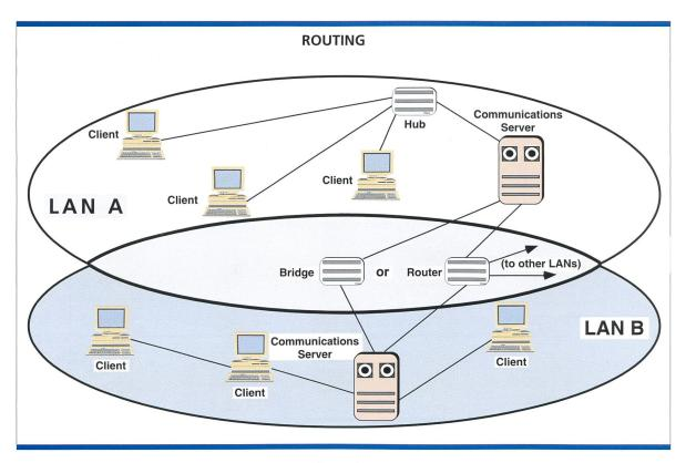
Bild 7. Klassisches Routing oder Bridging in einer LAN-Umgebung.
