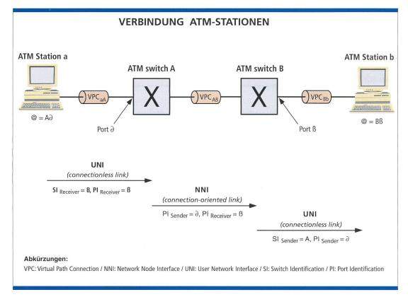
Bild 2. Verbindung zweier ATM-Stationen über Kurzadressen. VPC: Virtual Path Connection, NNI: Network Node Interface, UNI: User Network Interface, SI: Switch Identification, PI: Port Identification.
