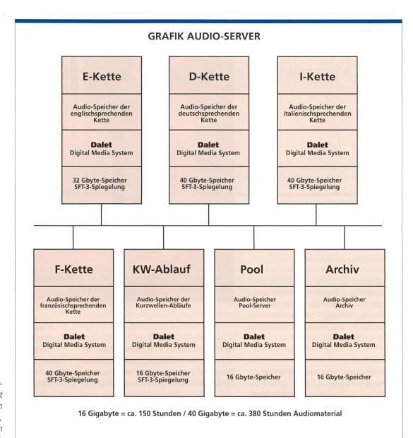
Bild 1. Multiserver-Gesamtnetzwerk mit fünf Kettenservern 16 GByte = rund 150 h, 40 GBytes = 380 h Audiomaterial.
