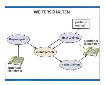
Bild 5. Weiterschalten der Verbindung.
