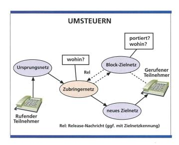
Bild 6. Umsteuern der Verbindung.
