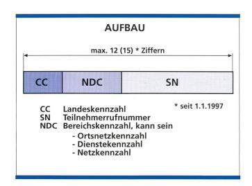
Bild 1. Aufbau der Rufnummer nach ITU Rec. E.164.
