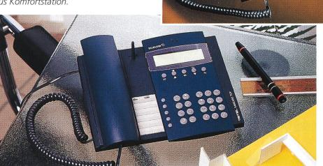
apparate gleichzeitig telefonieren (zehn Kanäle mit je zwölf Verbindungen). Zudem ist das DECT-Protokoll so ausgelegt, dass eine Vernetzung vieler Basisstationen zu einem Mikrozellularsystem möglich ist, wobei ein spezieller DECT-Algorithmus für das unbemerkte Umschalten von einer Zelle (Basisstation) zur anderen sorgt.
