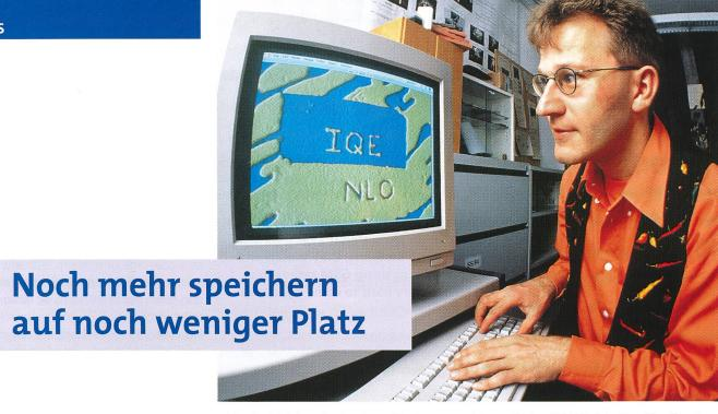
IQE: die Initialen des Instituts für Quantenelektronik der ETH Zürich. Der Physiker Lukas Eng kontrolliert auf seinem Computerbildschirm die Buchstaben, die in Wirklichkeit weniger als 1 Tausendstelmillimeter gross sind. Hintergrund und Schriftzeichen bestehen aus entgegengesetzt gerichteten elektrischen Feldern auf ferroelektrischem Material, durch das Rasterkraftmikroskop manipuliert und sichtbar gemacht.
